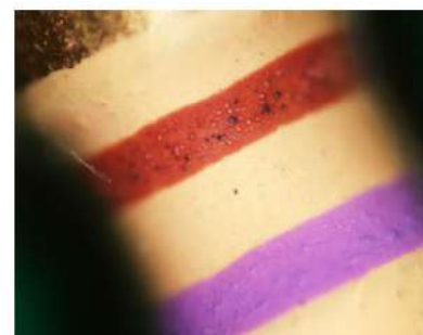
将部分点亮的环形照明从各种角度照射到样品上。通过用PRECIV合成各个记录图像良好的部位，有效地除去照明的写入
