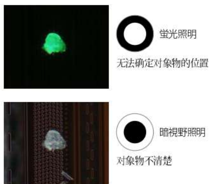
晶片样品上光致抗蚀剂的残渣
